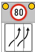
K19-1 Signalna ploča za označavanje mjesta radova na cesti i mjesta gdje je zadan smjer ili način preusmjeravanja prometa
